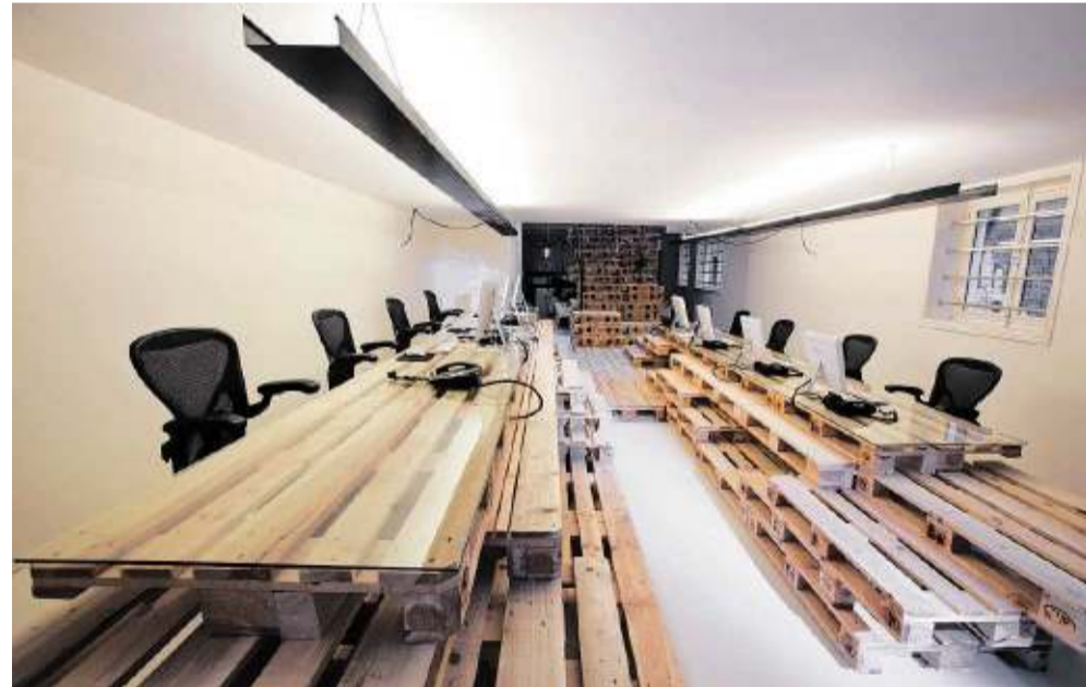
Most Architecture was verantwoordelijk voor de inrichting van het tijdelijke kantoor van het Amsterdamse reclamebureau Brandbase. Pallets bleken ideaal bouwmaterial voor bureaus. Op de bovenste pallet ligt een glasplaat als werkblad. De metalen U-profielen aan het plafond die meestal worden gebruikt voor stroom- en netwerkkabels, werden zwart gespoten en doen nu dienst als langgerekte lampekappen. Foto's Rogier Jaarsma
