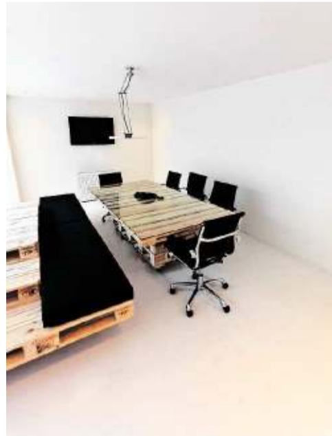
Most Architecture was verantwoordelijk voor de inrichting van het tijdelijke kantoor van het Amsterdamse reclamebureau Brandbase. Pallets bleken ideaal bouwmaterial voor bureaus. Op de bovenste pallet ligt een glasplaat als werkblad. De metalen U-profielen aan het plafond die meestal worden gebruikt voor stroom- en netwerkkabels, werden zwart gespoten en doen nu dienst als langgerekte lampekappen. Foto's Rogier Jaarsma
