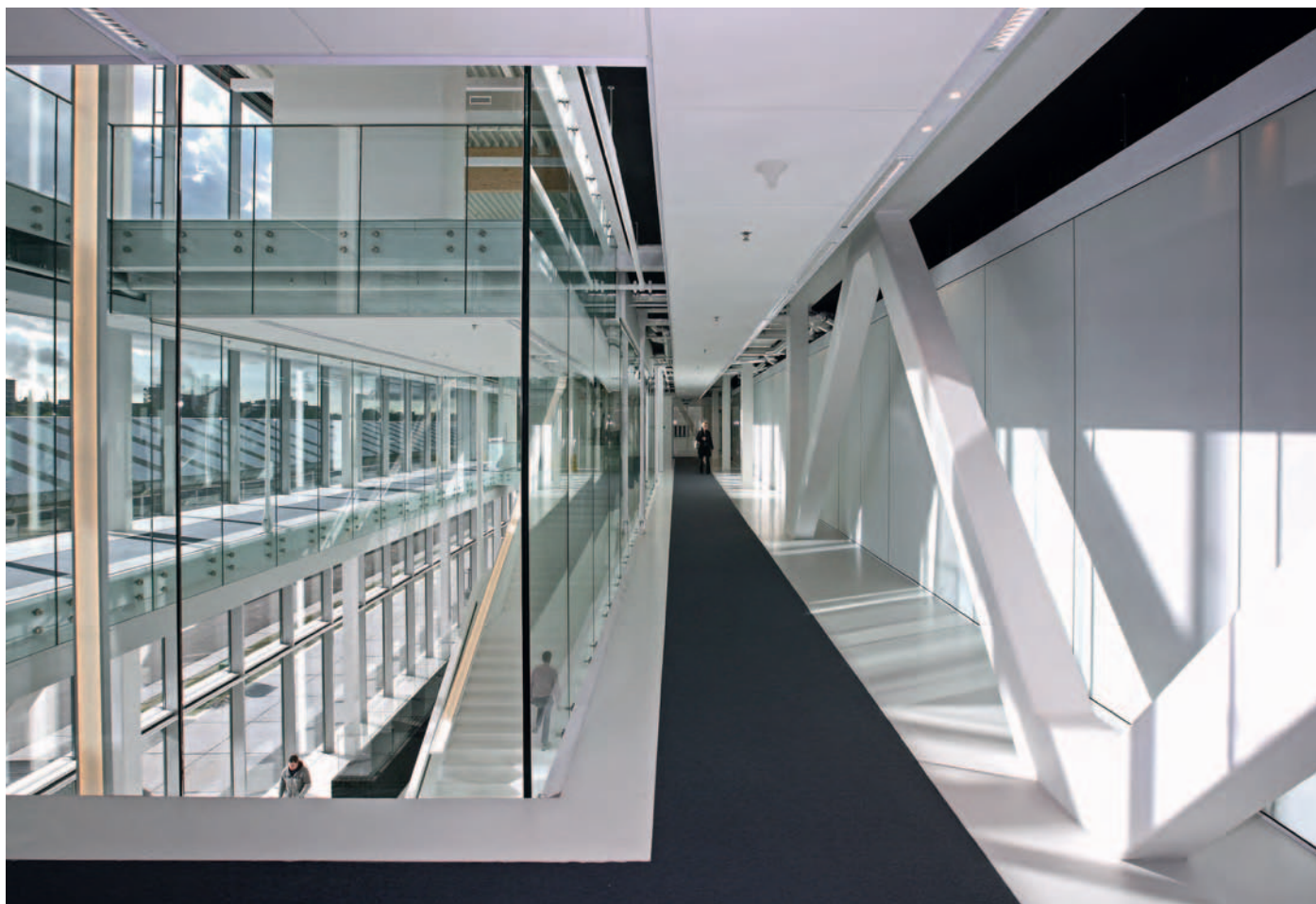
De transparante gevels brengen het daglicht diep in het open kantoorgebouw. De verlichting in het kantoorgedeelte is daglichtafhankelijk en via aanwezigheidsdetectoren geschakeld.
